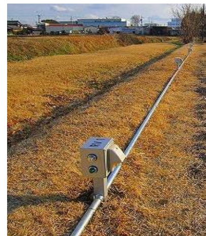
鉄パイプを用いた 敷設タイプ
